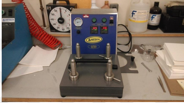
Fotoğraf 3.5. Sıvı azot ile dondurulan numunelere uygulanan basınç muamelesi
