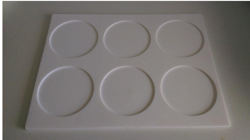
Fotograf 3.8. MCC kompozit filmlerin üretiminde kullanılan teflon kalıp
