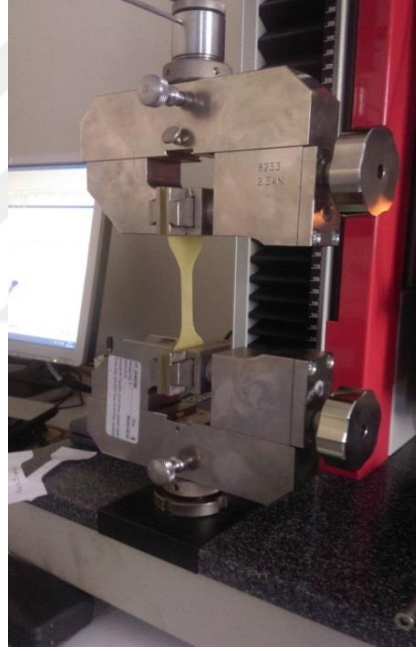
Fotoğraf 3.12. MCC kompozit filmlere yapılan çekme deneyi
