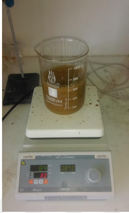
Fotoğraf 3.4. Numunelere uygulanan asit ve ikinci alkali muamele
