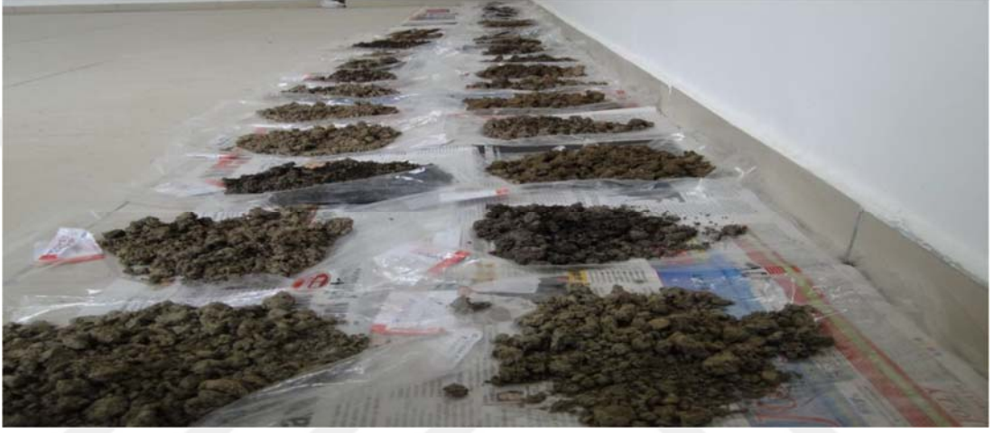
Fotoğraf3.5. Toprak numunelerinin hava kurusu hale getirilmesi
