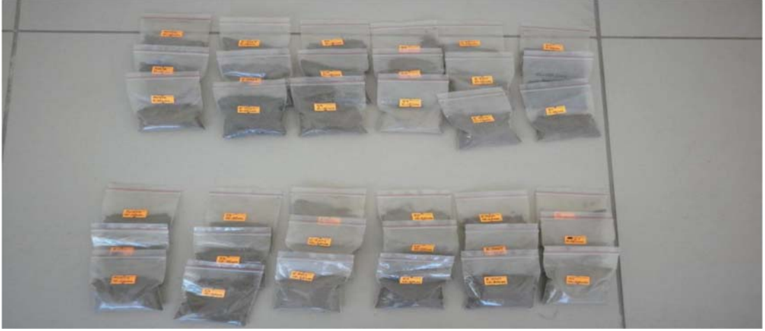
Fotoğraf3.7. 2 mm'lik elekten geçirildikten sonra analiz için naylon poşetlere konulmuş toprak numuneleri
