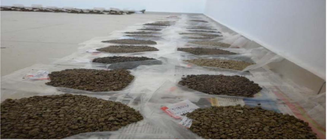
Fotoğraf3.6. Hava kurusu hale gelen toprak numuneleri
