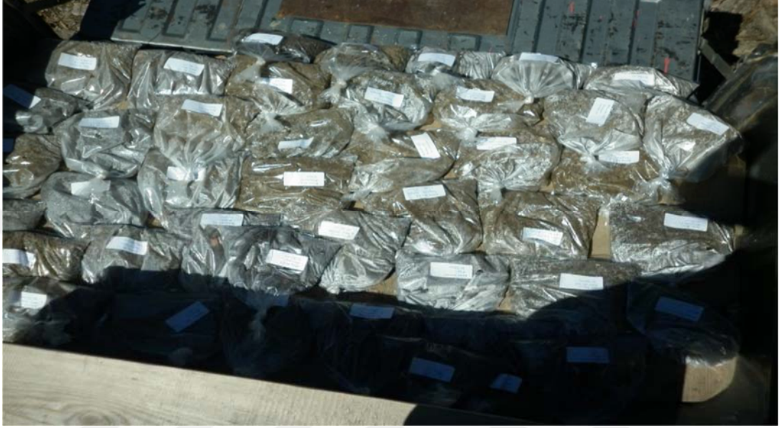
Fotoğraf3.3. Araziden alınan bozulmuş toprak numuneleri
