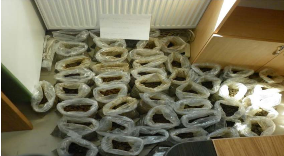
Fotoğraf3.4. Toprak numunelerinin laboratuvarında kurumaya bırakılması
