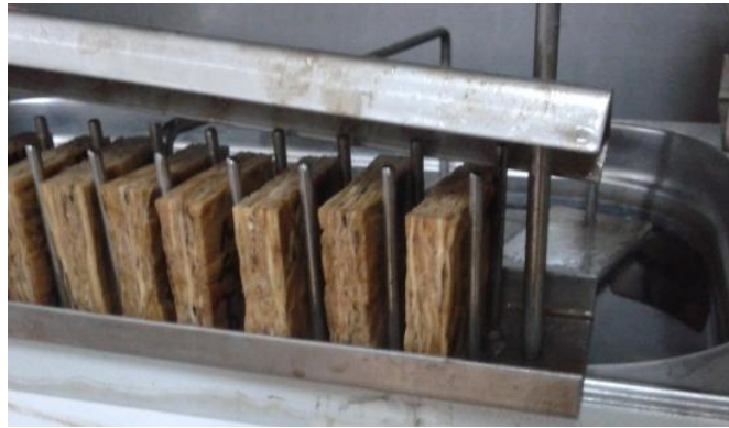
Fotoğraf 3.5. Suda kalınlığına şişme testi numuneleri
