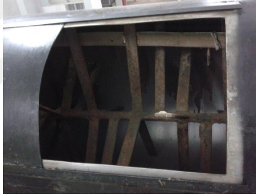
Fotoğraf 3.1. OSB üretiminde kullanılan blender
