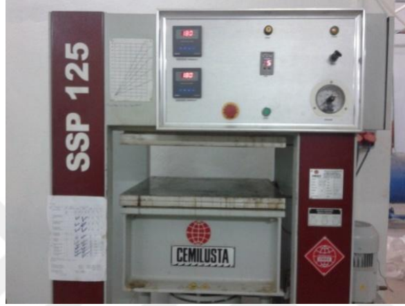
Fotoğraf 3.4. OSB üretiminde kullanılan hidrolik pres
