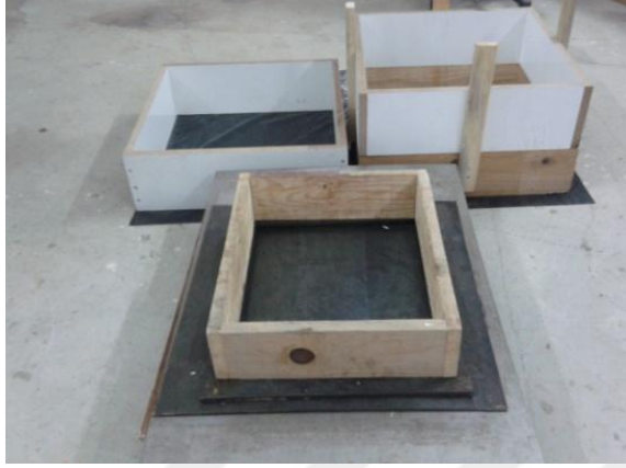
Fotoğraf 3.2 OSB üretiminde kullanılan kalıplar
