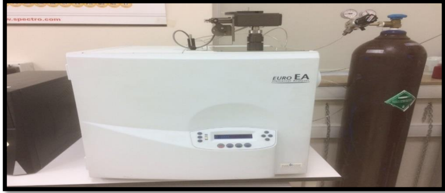
Fotoğraf 3.15. Eurovector EA3000-Tek CNH-S element analizörü.
