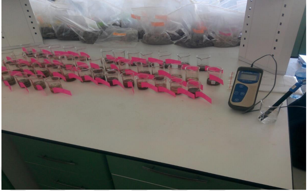
Fotoğraf 3.18. pH ölçer ve toprađın pH ölçümü
