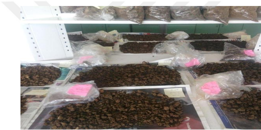
Fotoğraf 3.10. Laboratuvar altındaki havada kurutulan toprak örnekleri
