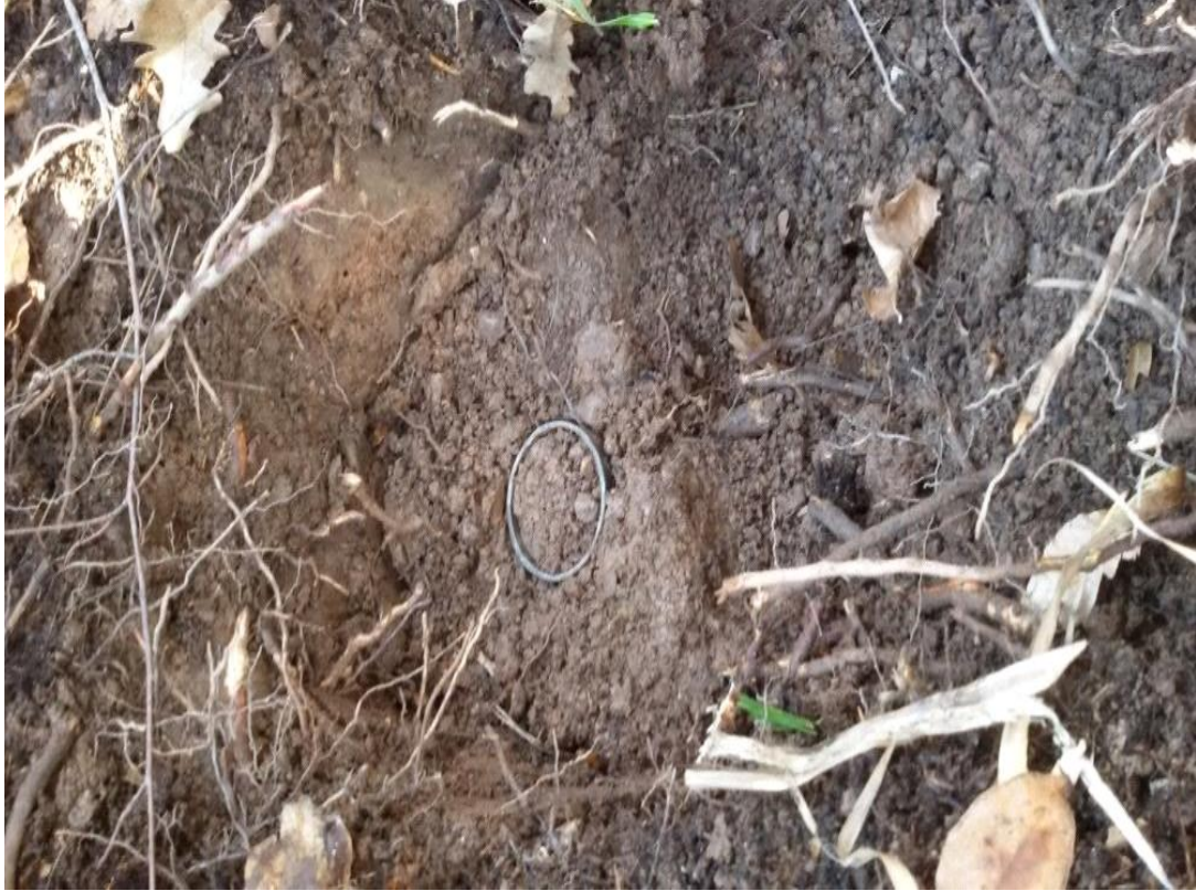
Fotoğraf 3.5. Toprak özleri kullanılarak farklı toprak derinliklerine göre toprak örnekleri almak için toprak çukurlarının kazılması
