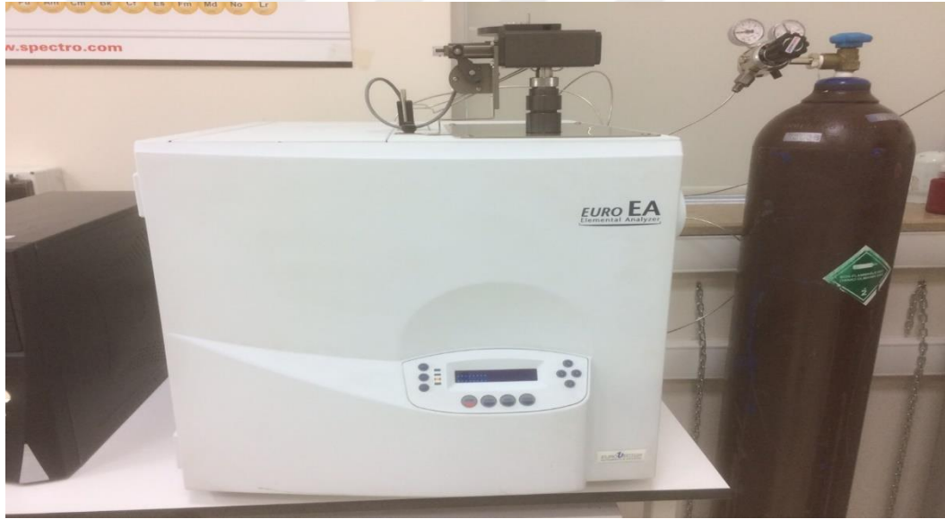
Fotoğraf 3.19. Eurovector EA3000-Single CNH-S element analizör
