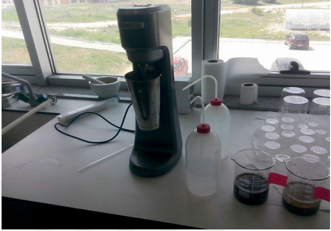
Fotoğraf 3.14. Mikserdeki toprak numunelerinin karışımı
