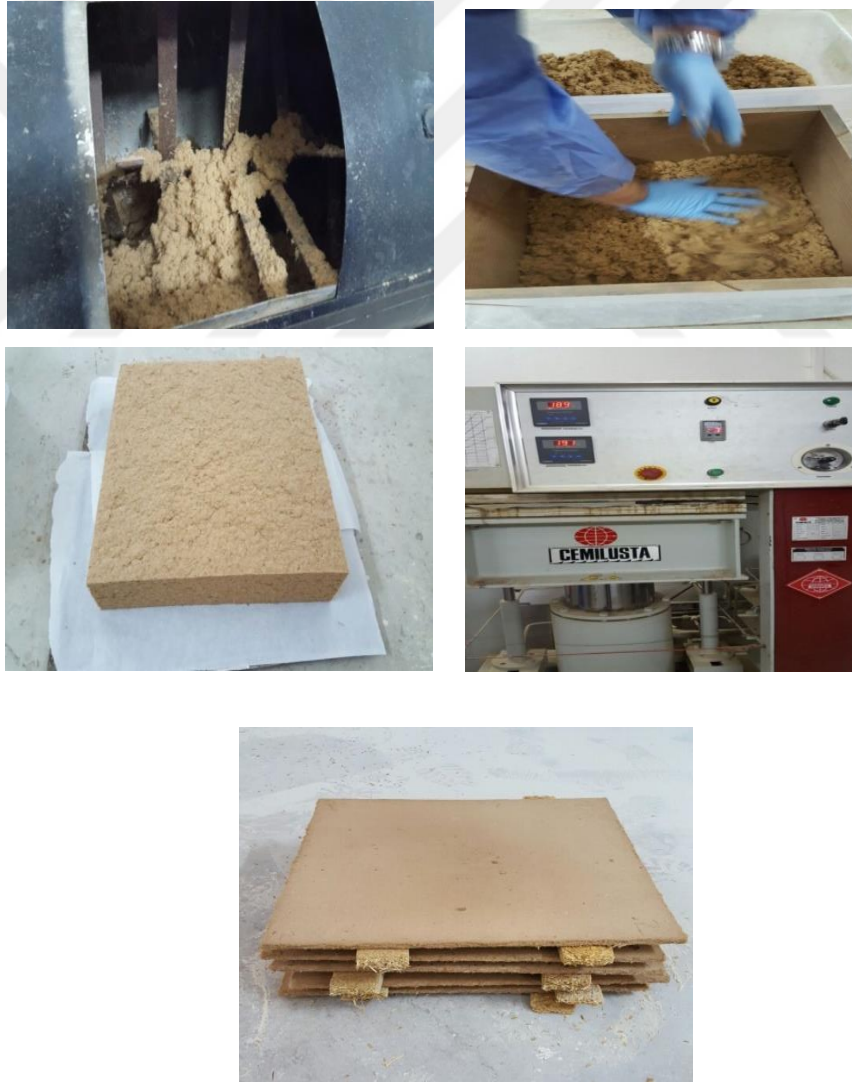
Fotoęraf 2.1. Laboratuvarda MDF levha ¼retim ařamaları
