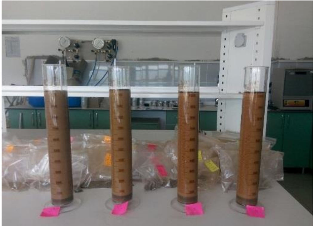
Fotoğraf 9. Hidrometre yöntemine göre doku belirlenmesi
