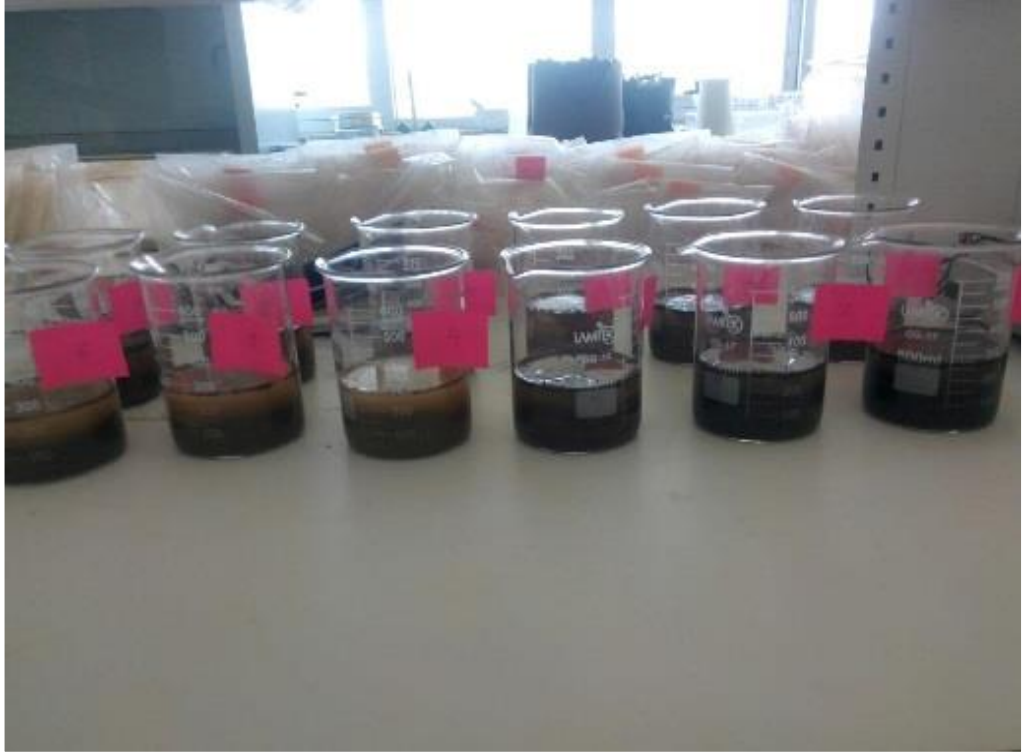
Fotoğraf 8. Hidrometre doku analizinden önce toprak numunesinin suda bekletilmesi
