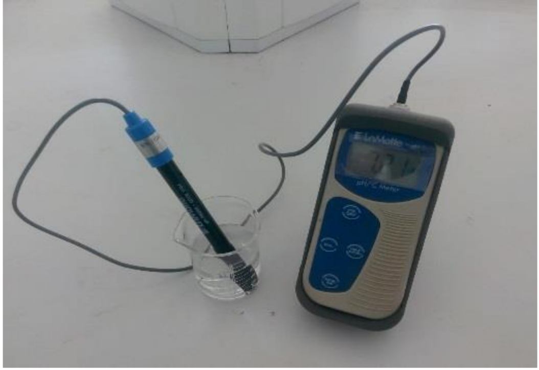
Fotoğraf 7. pH metre ile pH değerinin belirlenmesi
