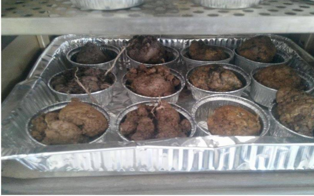
Fotoğraf 10. Fırına koyulan toprak numunelerinin kitle yoğunluğunun belirlenmesi
