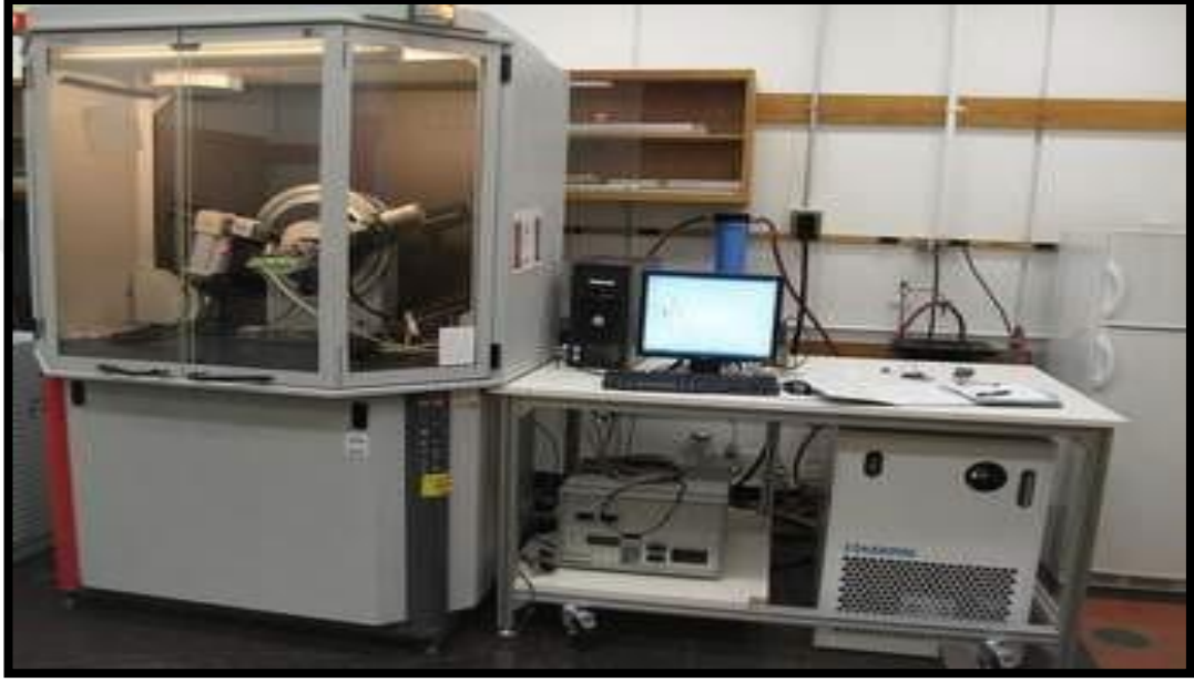
Fotoğraf 3.11. X – Işını difraksiyon makinası – XRD.
