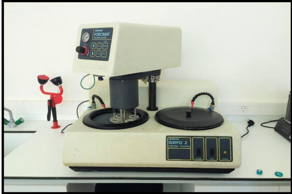
Fotoğraf 3.7. Örneklerin taşlama ve parlatma makinası işlemi.
