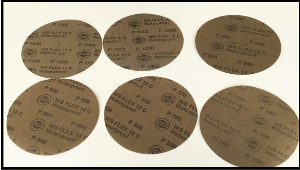
Fotoğraf 3.6. Taşlamada kullanılan zımpara kağıdı seti.
