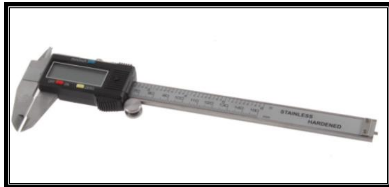
Fotoğraf 3.1. İB, İG, İÇ ve KÇ karakterlerinin ölçüm işlemlerinin kullanılan digital mikrokompas
