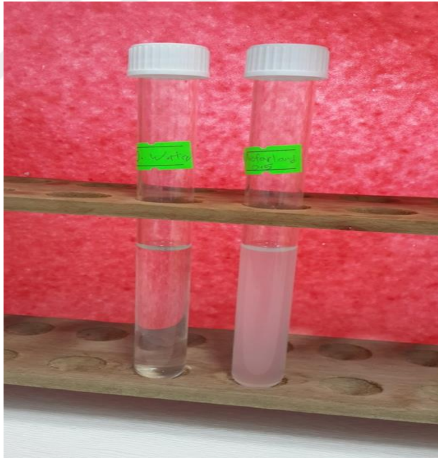
Fotoğraf 3.16. 0,5 McFarland standartının saf su ile karşılaştırılması
