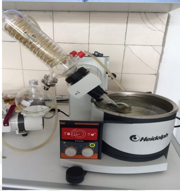
Fotoğraf 3.6. Döner buharlaştırıcı ile alkolün çıkarılması
