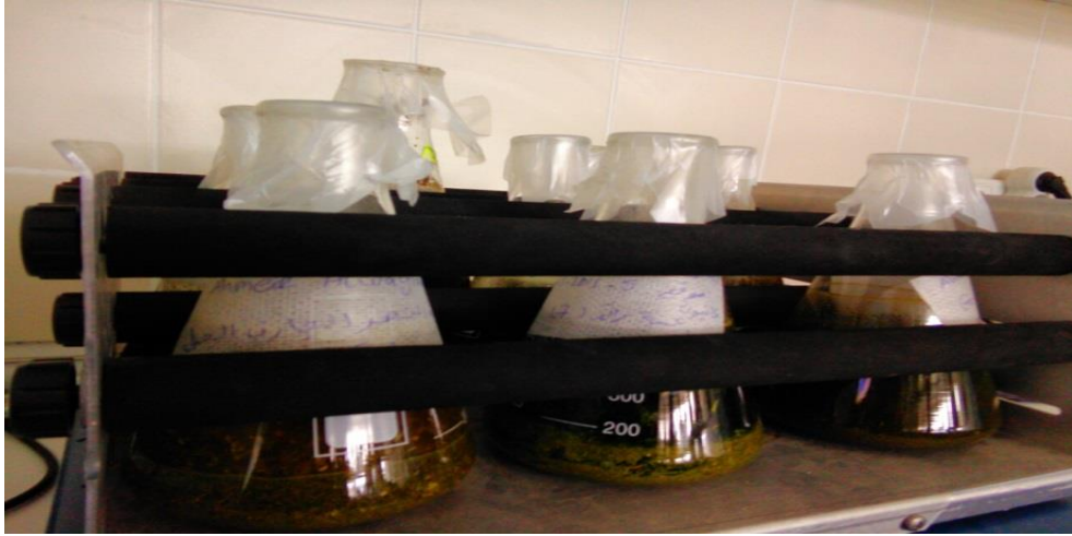
Fotoğraf 3.4. Çalkalama ile ekstrasyon işlemi
