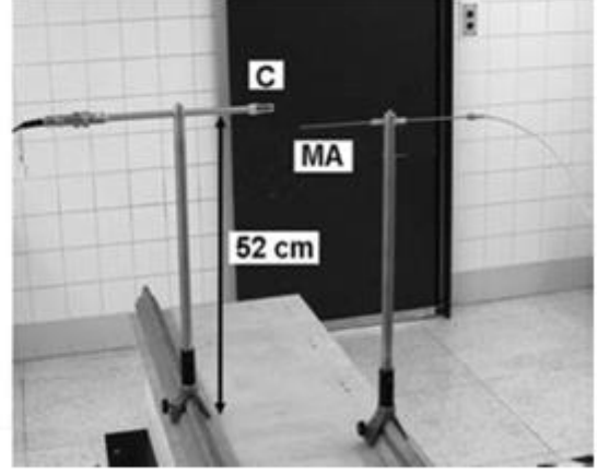
Fotoğraf 2.1. PDR ve HDR kaynakları için havadaki kalibrasyon örnekleri
