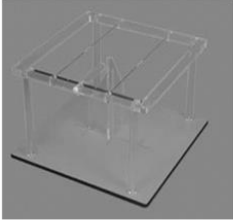
Fotoğraf 2.1. PDR ve HDR kaynakları için havadaki kalibrasyon örnekleri
