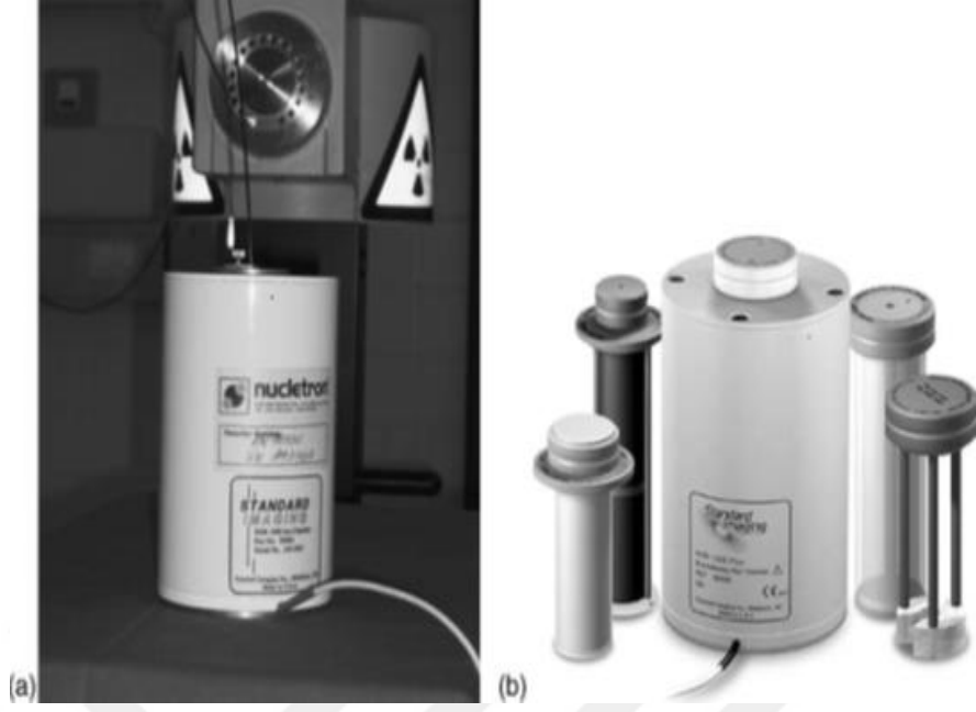
Fotoğraf 2.2. HDR-1000 kuyu tipi odanın standart görüntülemesi ((a) mikroselektron HDR postşarjlı kalibrasyon düzeneğinde HDR-1000. (b) Çok sayıda aplikatörlü farklı radyonüklit kaynakları için en son HDR-1000 Plus modeli.)
