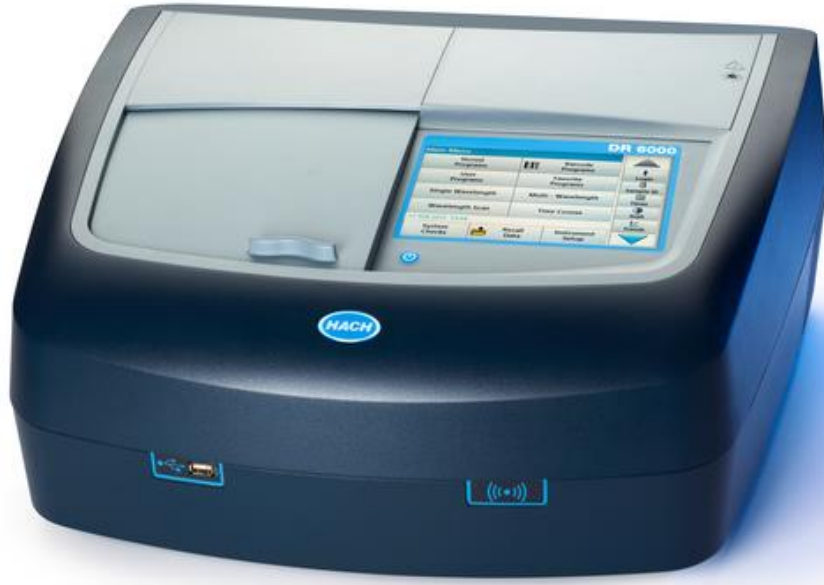
Fotoğraf 4. Kimyasal parametrelerin ölçüldüğü Spektrofotometre cihazı
