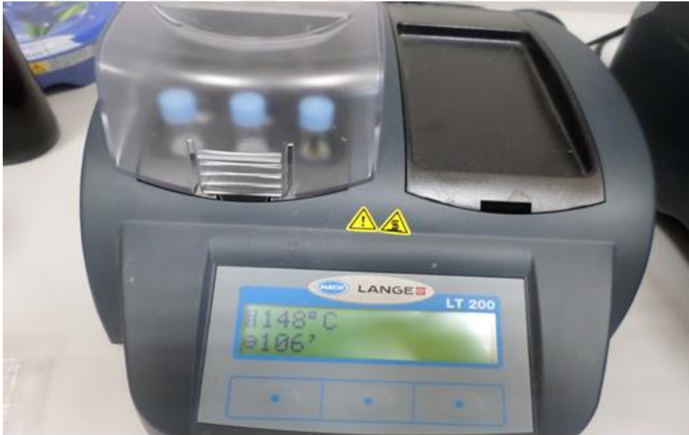
Fotoğraf 5. Kimyasal Oksijen İhtiyacının Ölçümünde kullanılan Termoreaktör
