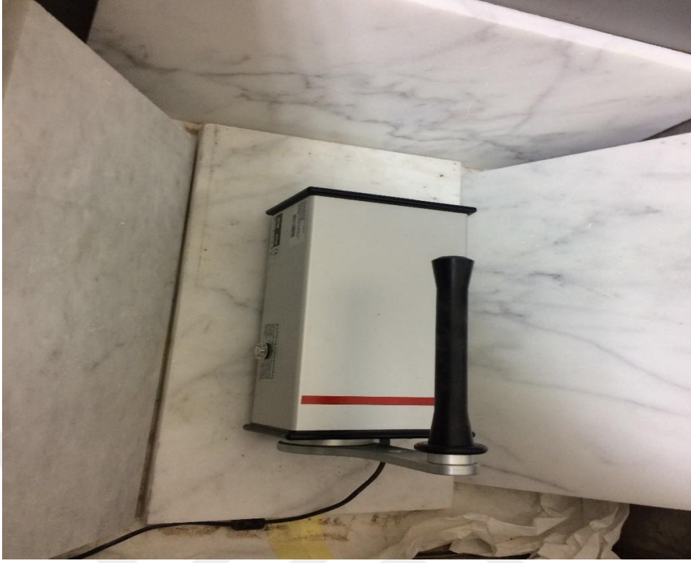
Fotoğraf 3.4'ün devamı Radon ve salım hızları için yapılan model hücre
