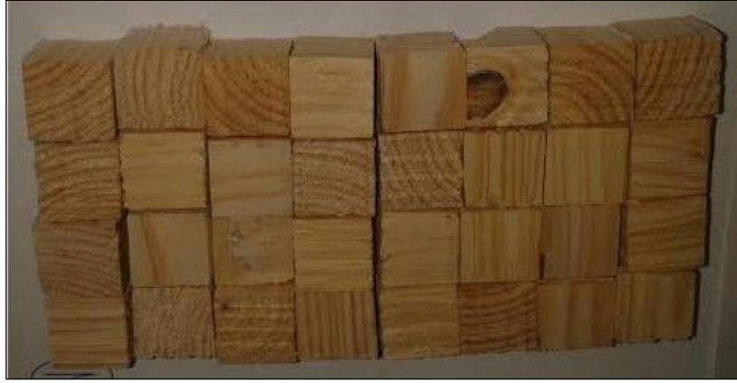
Fotoğraf 3.7. Mikrotomda kesit alınmak için suda kaynatılmış olan küp şeklindeki kızılçam örnekleri
