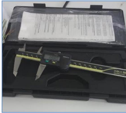
Fotoğraf 3.3. İbre uzunluğu ve kalınlığı ölçümünde kullanılan dijital kumpas
