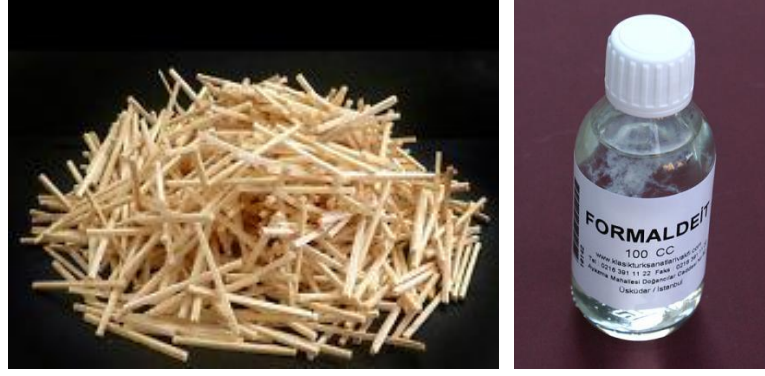
Fotoğraf 3.5. Liflerin maserasyonu için kibrit çöpü haline getirilen örnekler ve % 37'lik formaldehit çözeltisi
