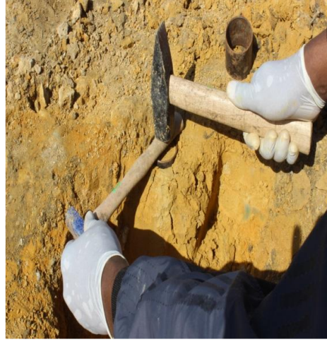
Fotoğraf 4. Çelik silindirlerle farklı toprak derinliğinden örnekleme
