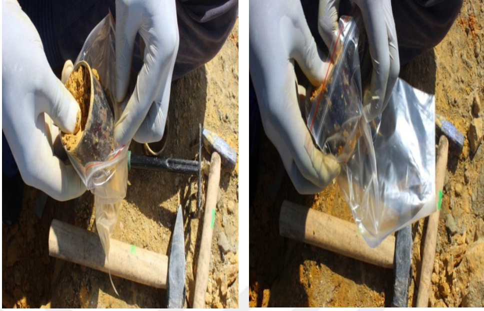
Fotoğraf 6. Silindir örnekleme topraklarının plastik torbaya boşaltılması
