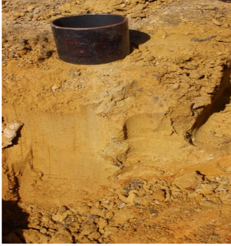
Fotoğraf 4. Çelik silindirlerle farklı toprak derinliğinden örnekleme
