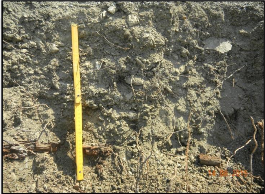
Fotoğraf 3.9.Toprak örneklerinin derinlik kademesinin belirlenmesi
