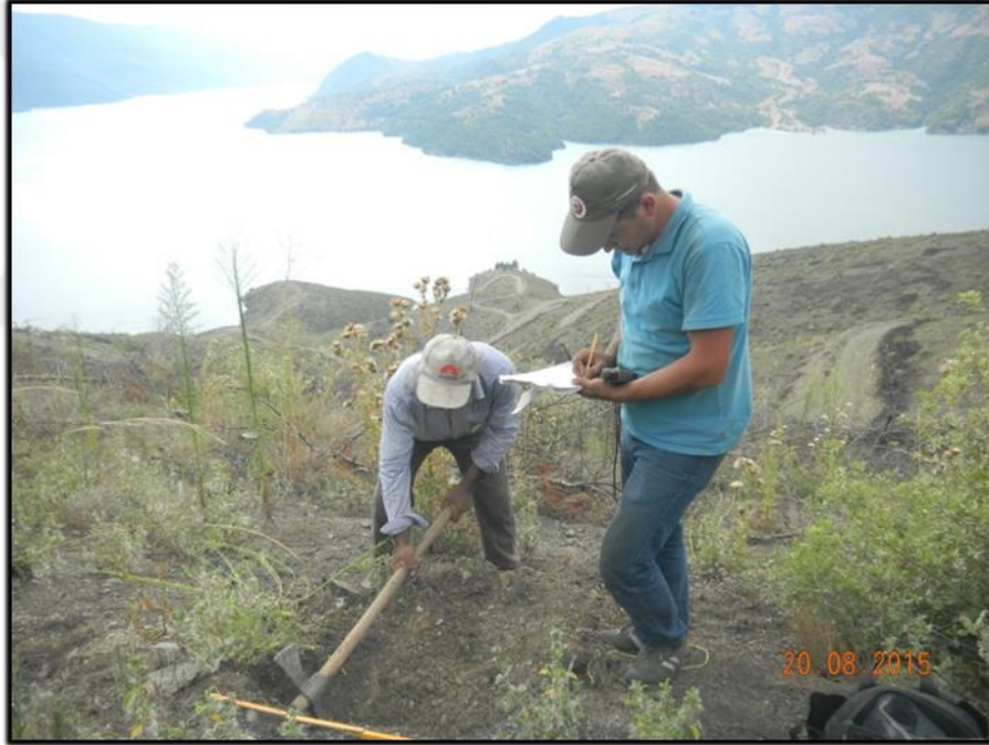
Fotoğraf 3.7.GPS ile belirlenen noktalardan toprak örneklerinin alınması
