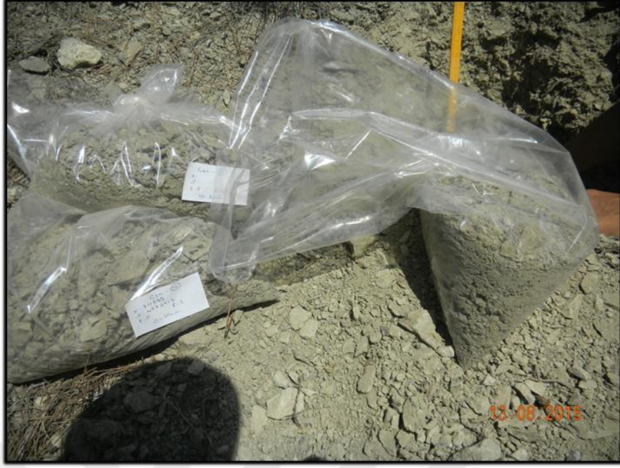
Fotoğraf 3.10.Derinlik kademlerine göre toprak örneklerinin alınması
