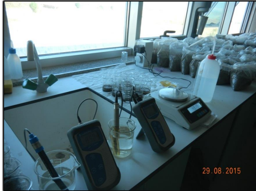
Fotoğraf 3.14.Toprak örneklerinin elektriksel iletkenlik değerlerinin ölçümü
