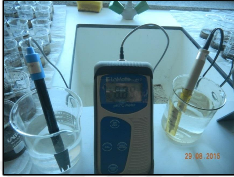
Fotoğraf 3.13.Hazırlanan toprak örneklerinin pH değerlerinin ölçümü
