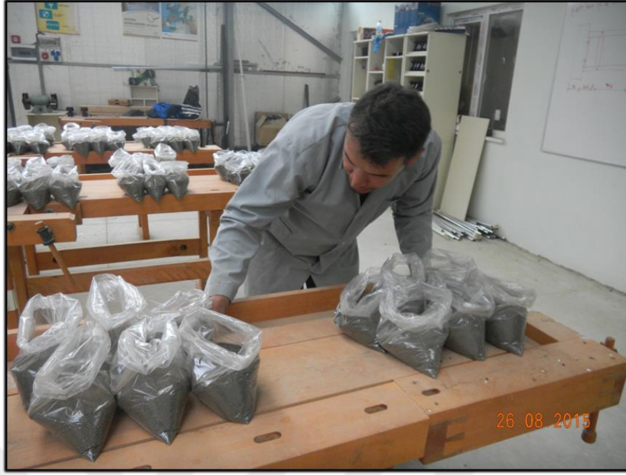
Fotoğraf 3.11.Elenen örneklerin torbalara doldurularak analize hazırlanması
