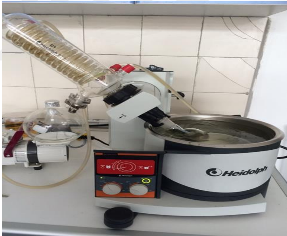
Fotoğraf 3.3. Rotary evaporatörle ekstrakt içindeki çözücünün uçurulması
