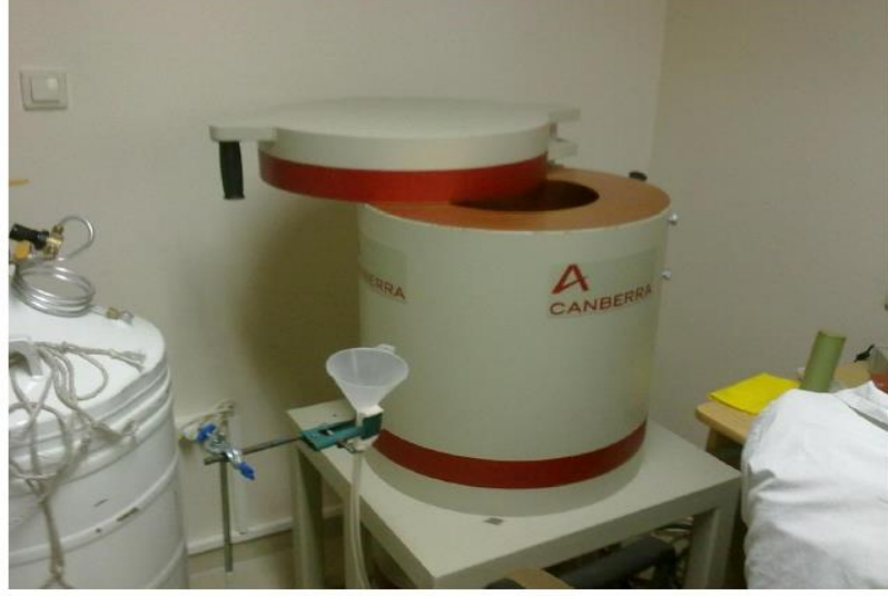
Şekil 2.1. Saf germanyum detektörlü gama spektrometrik ölçüm sistemi
