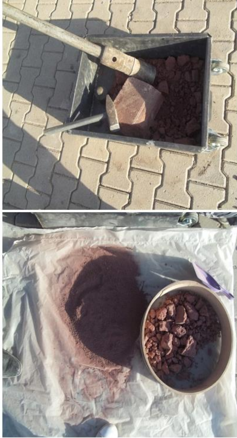
Fotoğraf 3.1. Tüf örneklerinin kırılması için kullanılan düzenek (Atıcı, 2016)
