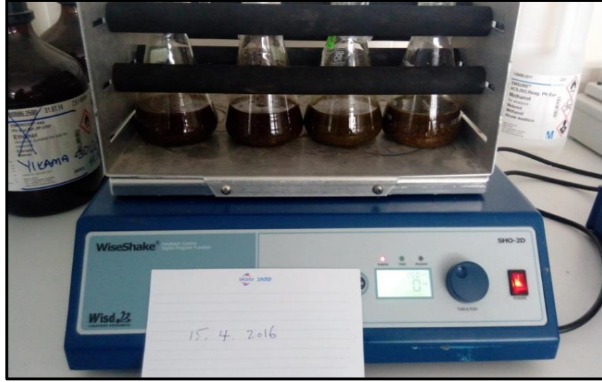
Fotoğraf3.9.Bitki örneklerinin çalkalayıcıda ekstraksiyona bırakılması
