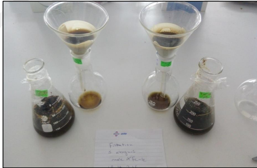
Fotoğraf3.10.Filtre kağıdı kullanarak bitki materyallerinin süzölməsi
