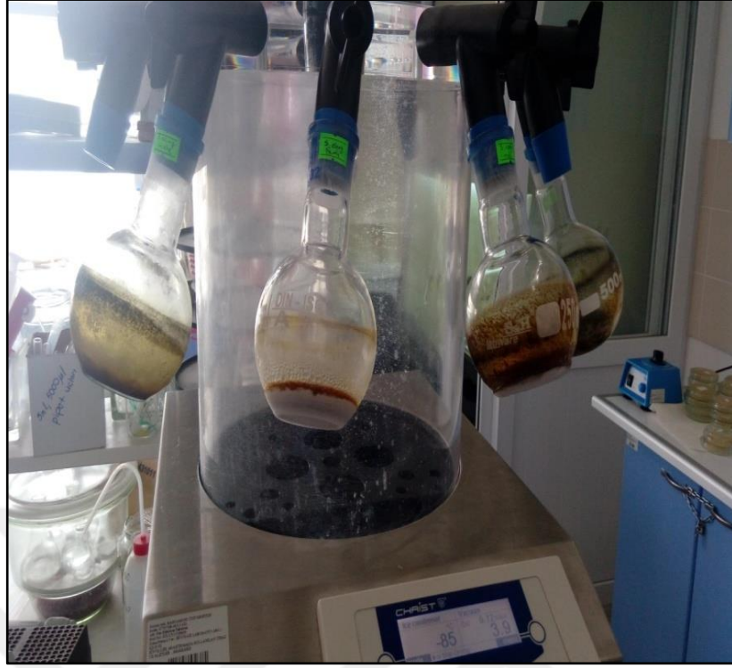
Fotoğraf3.12.Liyofilizatör ile suyun buharlaştırılması
