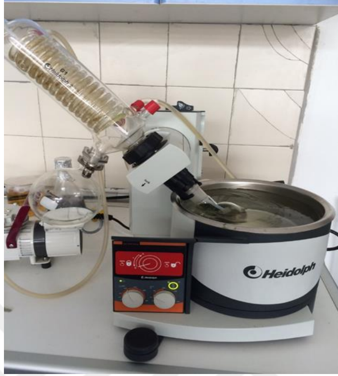
Fotoğraf3.11.Döner buharlaştırıcı kullanarak etanolün buharlaştırılması
