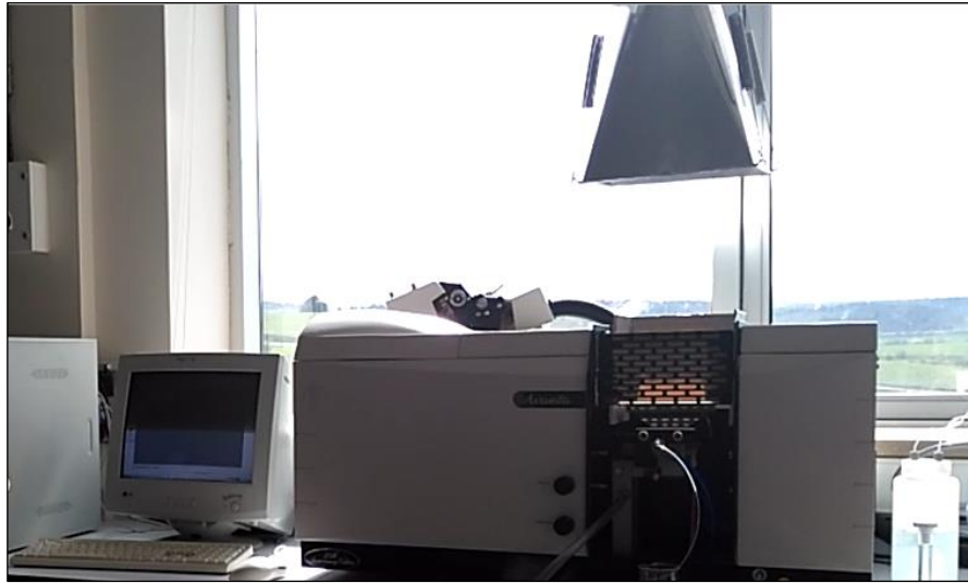
Fotoğraf 4.11. Alevli atomik absorpsiyon tekniği ug/mL (ppm) seviyesinde ile çalışan AAS cihazı
