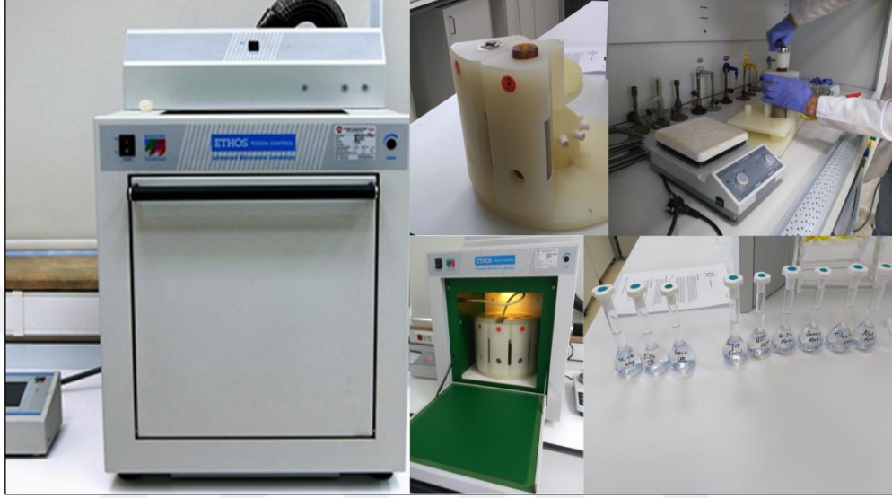
Fotoğraf 4.9. Kavak dokularına kapalı sistem yakma cihazı ile asit uygulaması
