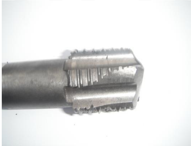
Şekil 1.3. Talaşlı imalat işlemi sırasında aşınmış kılavuz örneği
