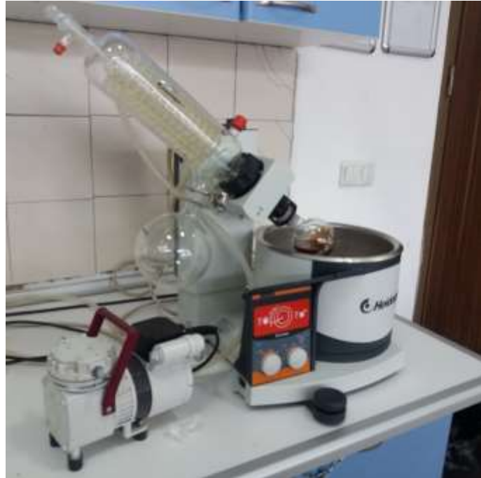
Fotoğraf 3.11. Döner Buharlaştırıcıda etanolün uzaklaştırılması.
