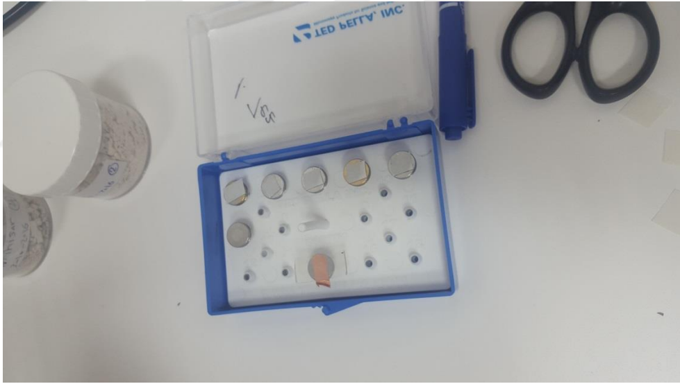
Fotoğraf 3.4. SEM ile tanecik boyut analizi için hazırlanan örnekler
