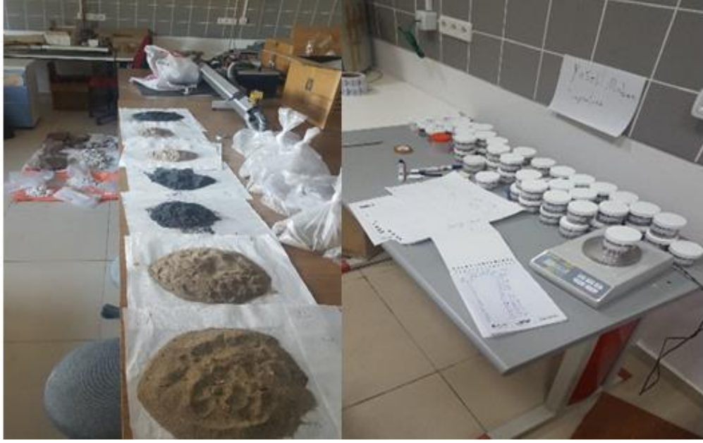
Fotoğraf 3.1. Radyoaktivite ölçme işlemi için hazırlanan örnekler
