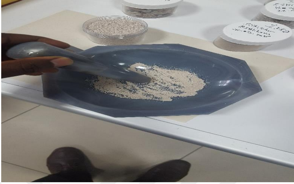
Fotoğraf 3.3. XRD ile analizi için hazırlanan örnekler
