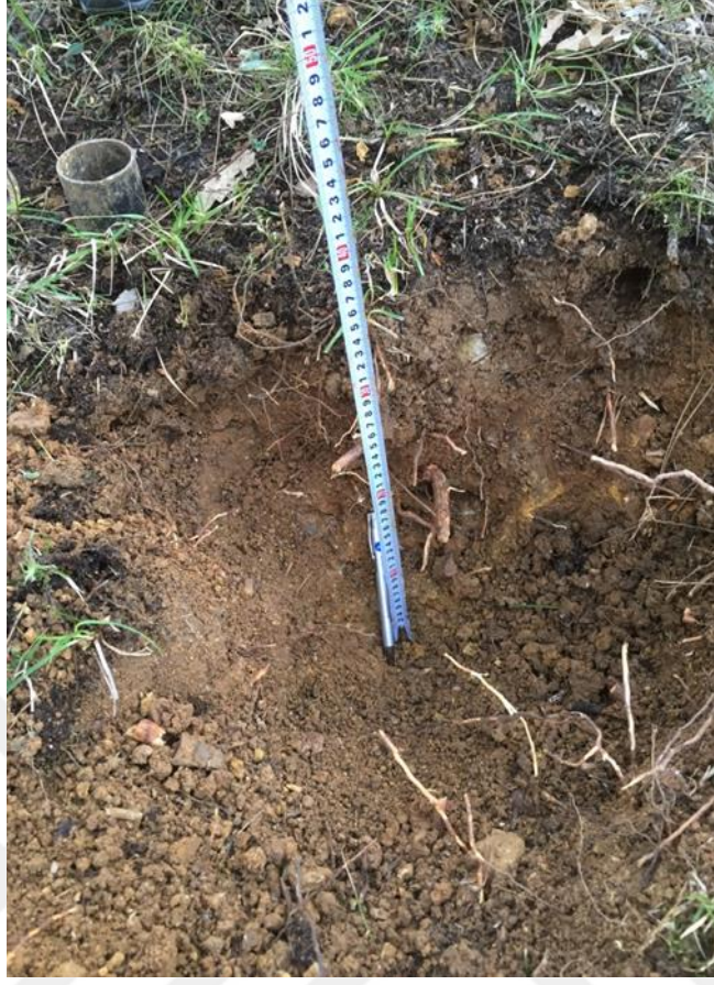
Fotoğraf 3.2. Toprak silindirleri kullanılarak farklı derinliklerden toprak örneklerinin alınması
