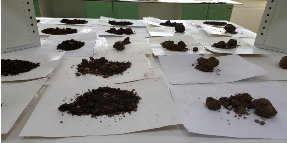
Fotoğraf 3.6. Laboratuvarda kurutulan toprak numuneleri.
