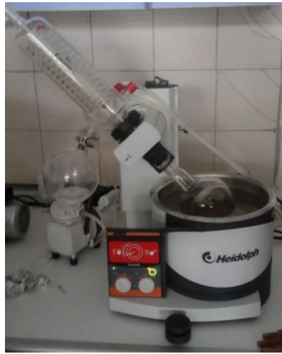
Fotoğraf 3.4. Evaporatör yardımıyla bitkilerden özüt elde edilmesi
