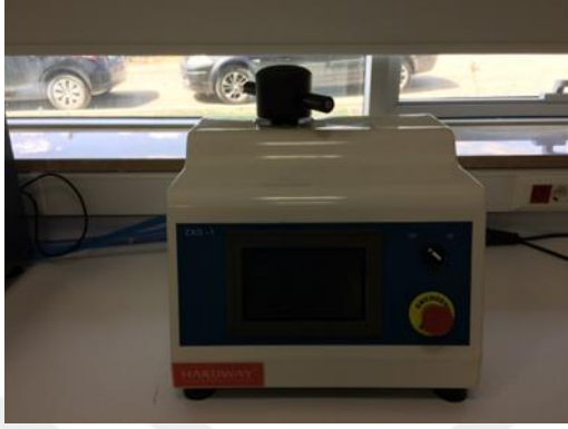
Şekil 7.2. Bakalite alma cihazı
