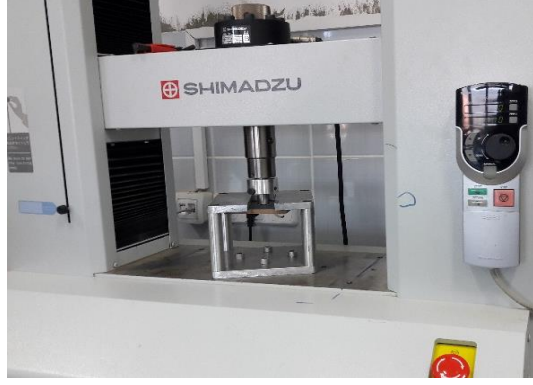
Fotoğraf 4.9. Üniversal test cihazı
