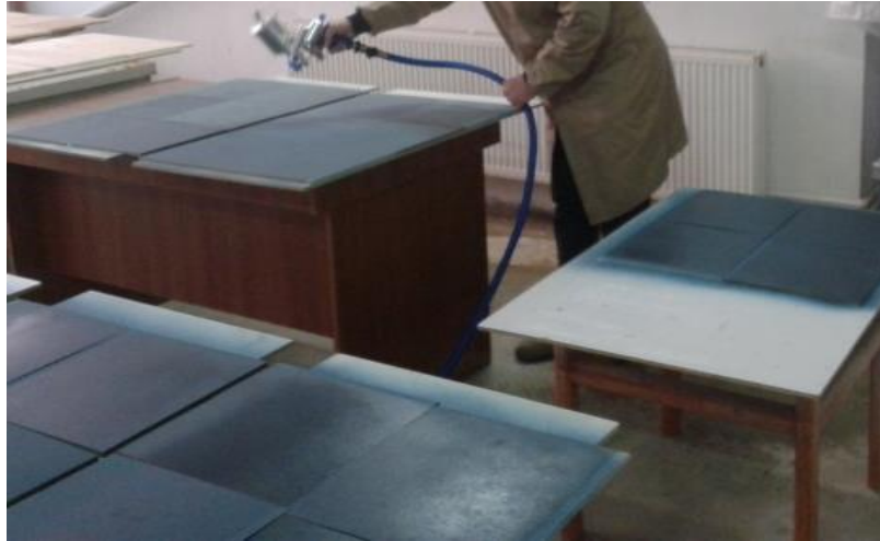
Fotoğraf 4.3. Su bazlı ısı yalıtım boyasının uygulaması
