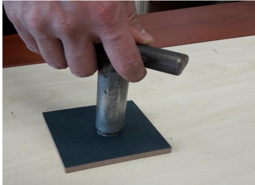
Fotoğraf 4.8. Çelik silindirin kenarlarından boya katmanının kesilmesi
