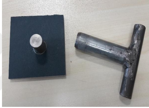
Fotoğraf 4.7. Çelik silindirin deneş örneğine yapıştırılması
