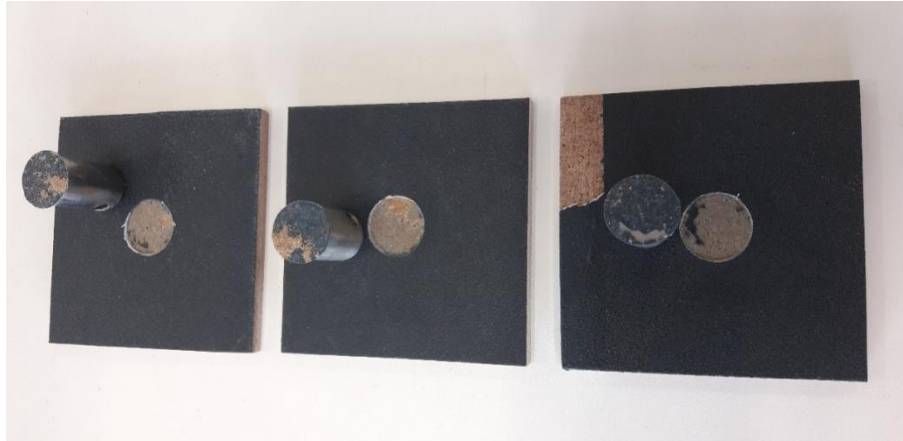
Fotoğraf 4.11. Yapışma test sonunda numunelerin durumu
