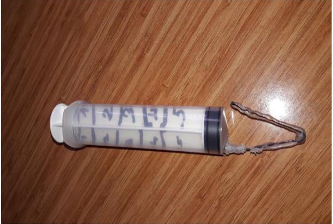
Fotoğraf 3.7. Deney grubu öğrencilerinin tasarladığı dinamometre görseli-5
