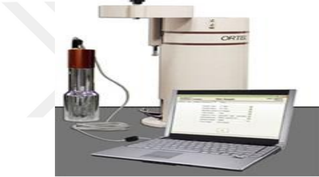
Fotoğraf 2.3. NaI(Tl) sintilasyon dedektörünün görünümü
