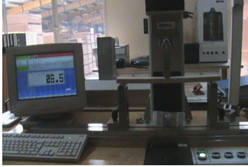
Şekil 3.4. Eğilme direnci test düzeneği
