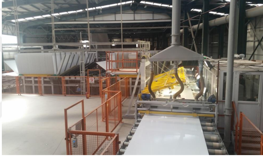
Şekil 1.14. Melamin kaplama tesisi kalite seçim istasyonu ve yıldız soğutma kolları genel görünüşü
