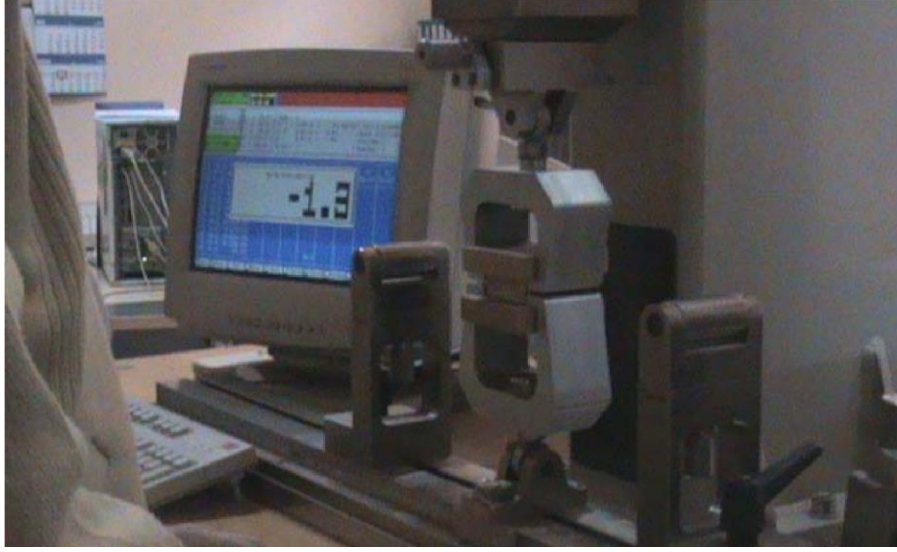
Şekil 3.5. Yüzeye dik yönde çekme direnci testi
