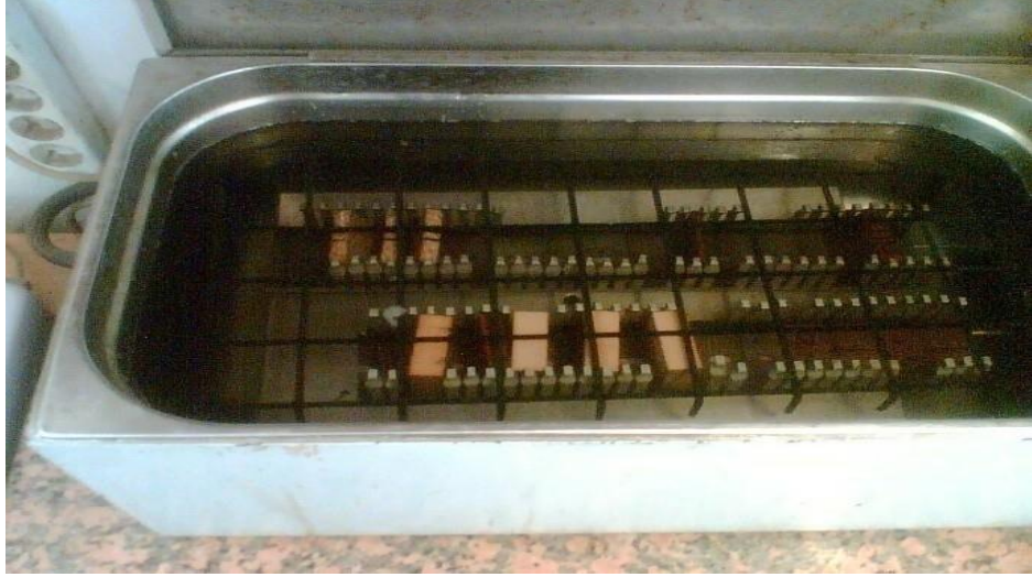
Şekil 3.3. 24 Saat suda kalınlığına şişme ve su emme test cihazı
