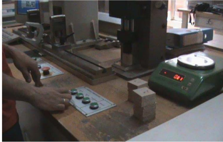
Şekil 3.2. Yoğunluk test düzeneği
