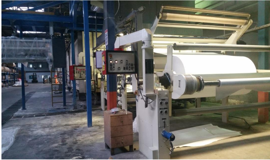
Şekil 1.12. Ham kağıt bobininin üretim hattına verilmesi
