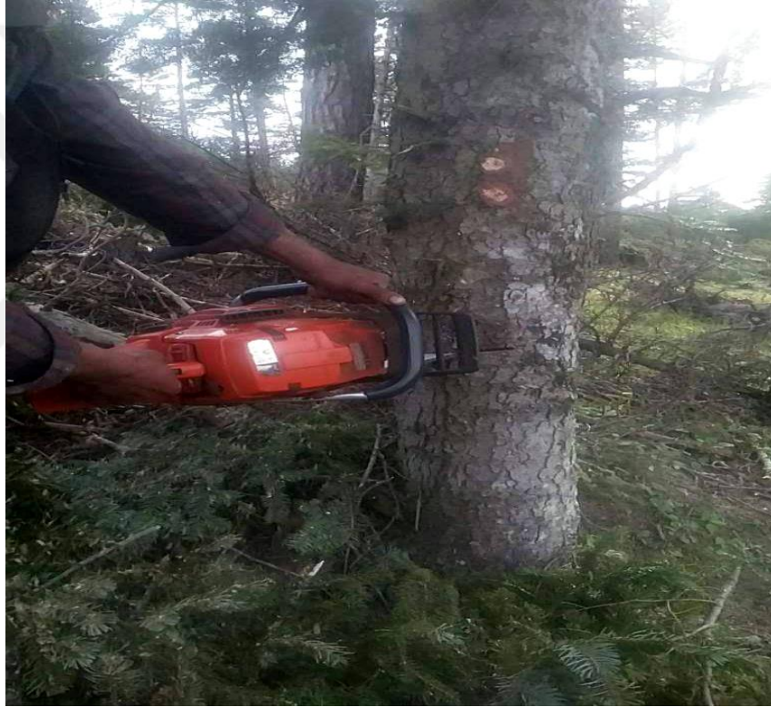
Fotoğraf 3.1. Çalışma alanlarında kesilen ağaçlardan diskler alınırken motorlu testere kullanılması
