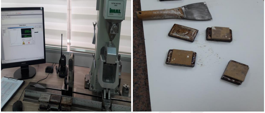
Fotoğraf 3.4. Çekme dayanımı test düzeneği
