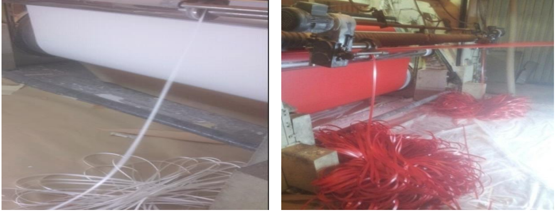
Fotoğraf 1.16. Emprenye makinesi kenar kesici fireleri
