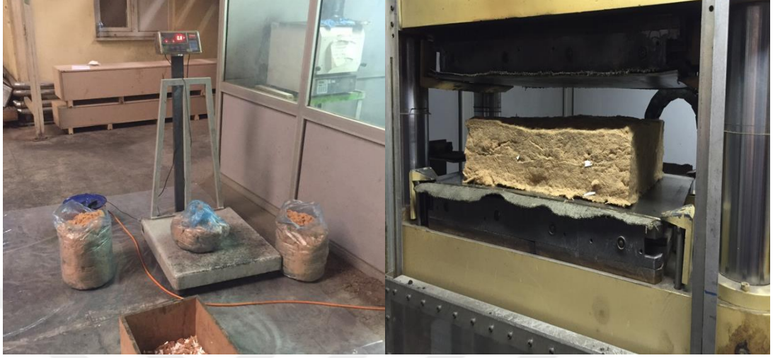
Fotoğraf 3.2. Test levhalarının dozajlanması ve basılması
