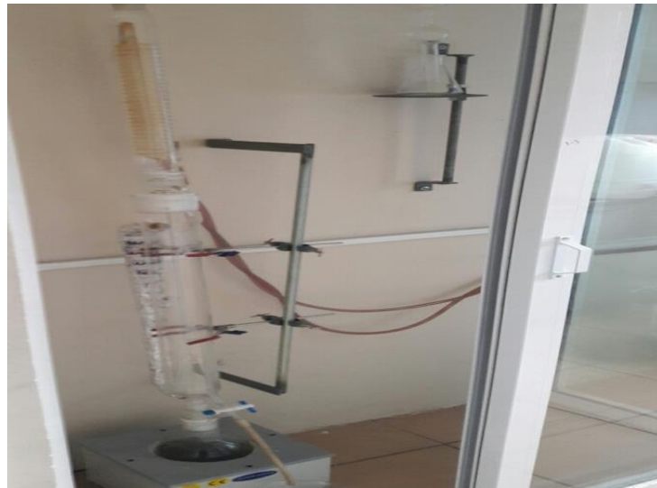
Fotoğraf 3.7. Perforatör ile Ekstraksiyon test düzeneği
