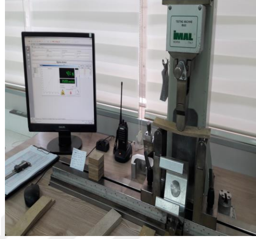
Fotoğraf 3.5. Eğilme dayanımı test düzeneği
