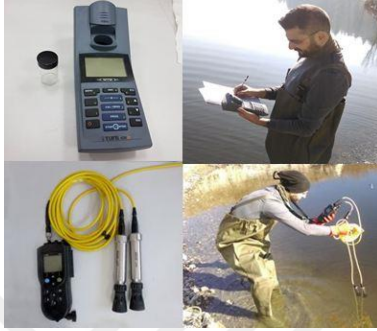
Fotoğraf 3.2. Türbidimetre ve multimetre cihazları ile yapılan anlık ölçüm çalışmaları
