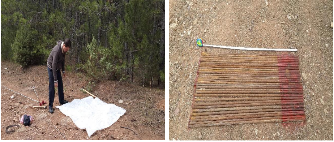
Fotoğraf 3.1. Sediment tuzakları için kullanılan geotekstil malzemeler ve nervürlü demir kazıklar
