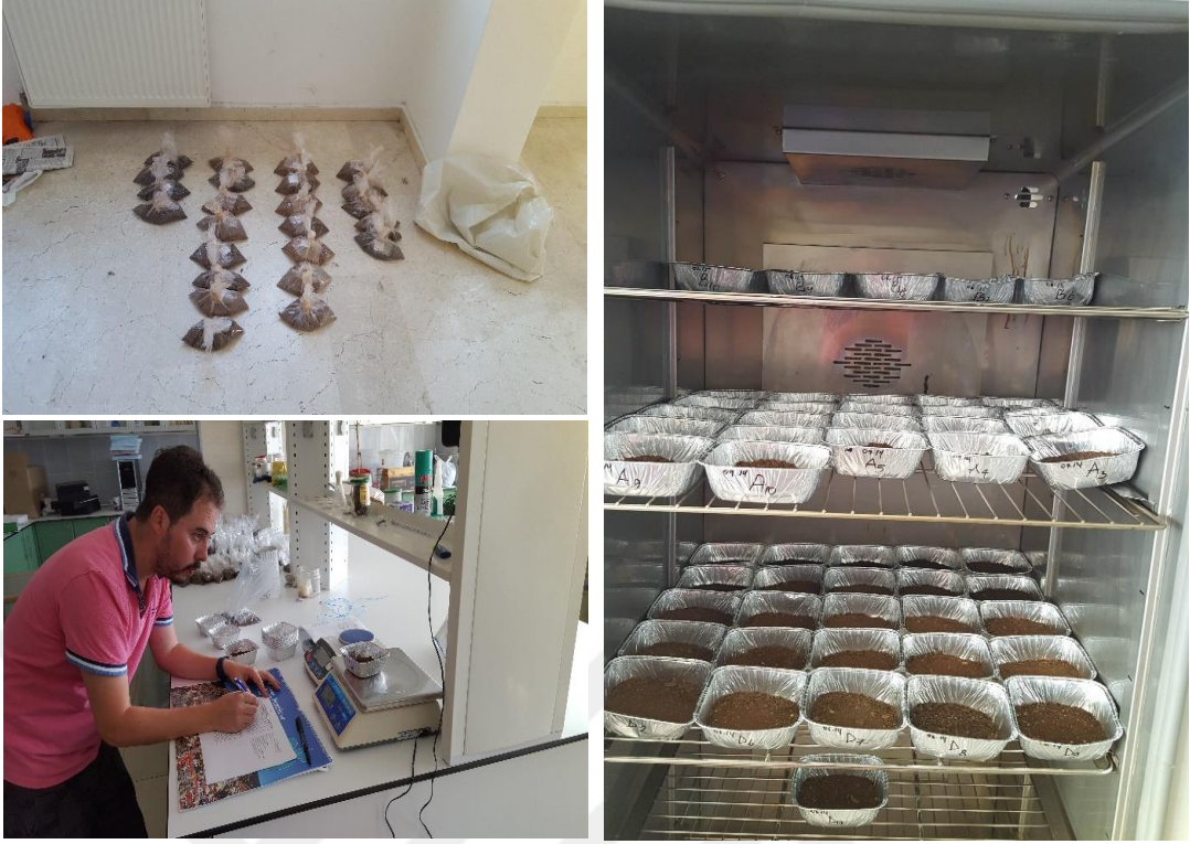
Fotoğraf 3.5. Toplanan sedimentlerin laboratuvarında tartılması, kurutulması ve örnekleme
