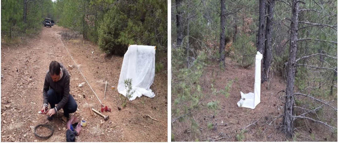
Fotoğraf 3.2. Sediment tuzaklarının hazırlanması, yol kenarlarına ve meşcere içerisine kurulumu
