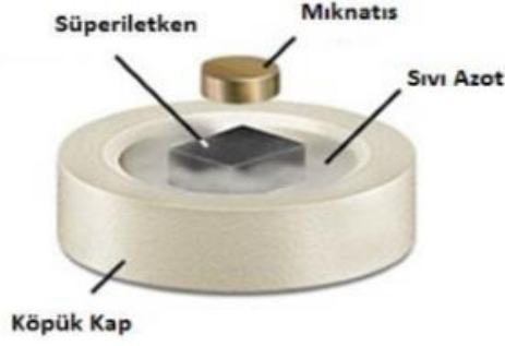
Şekil 2.7. Süperiletken malzemenin manyetik alanı dışarlaması
