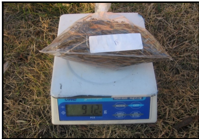
Fotoğraf 6. Arazide alınan yanıcı maddelerin hassas terazi ile tartılması
