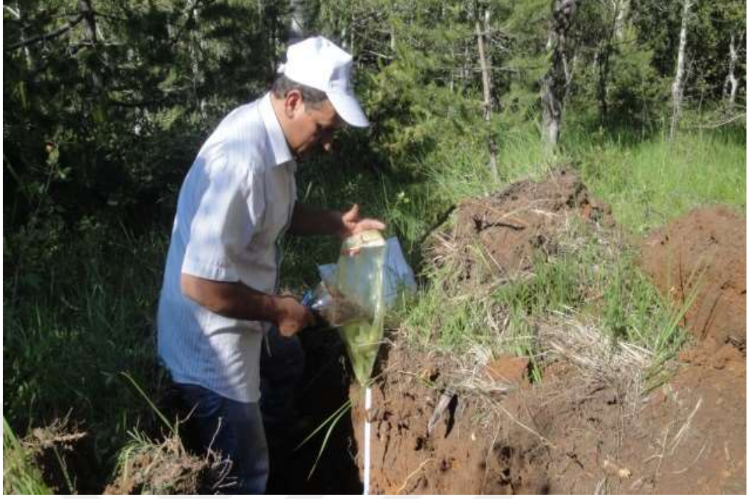
Fotoğraf 3. 9. Toprak profilinden toprak örneđi alımı
