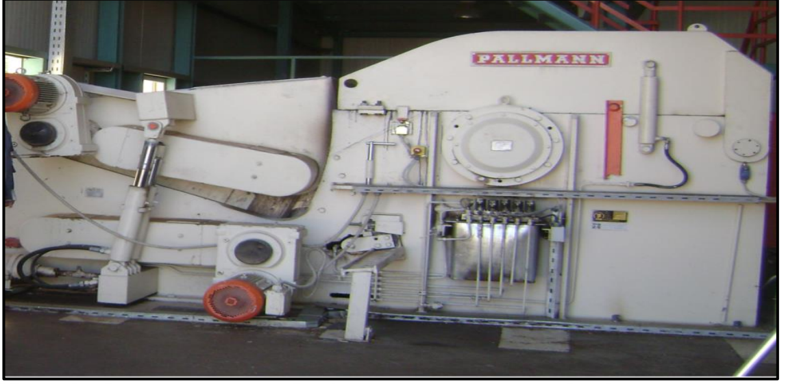
Fotoğraf 2. 1. Chipper kaba yongalama makinası (Gözalın, 2016.)
