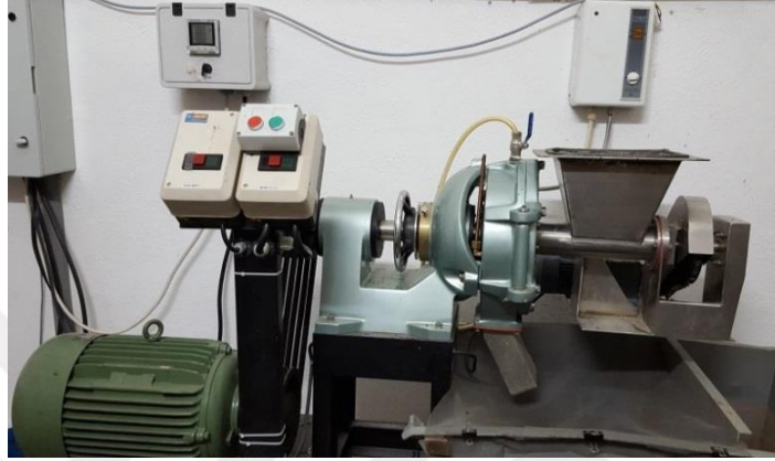
Şekil 4.3. Laboratuvar tipi liflendirme rafinörü (Foto: Başarır, 2015).
