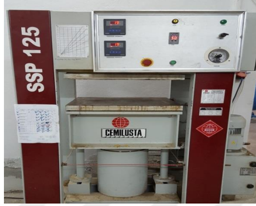
Şekil 4.5. Cemil usta marka hidrolik pres (Foto: Başarır, 2015).
