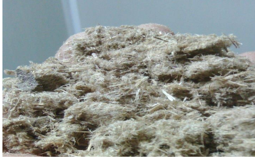
Şekil 4.8. Laboratuvar tipi liflendirme rafinöründe üretilen lifler (Foto: Başarır, G.)
