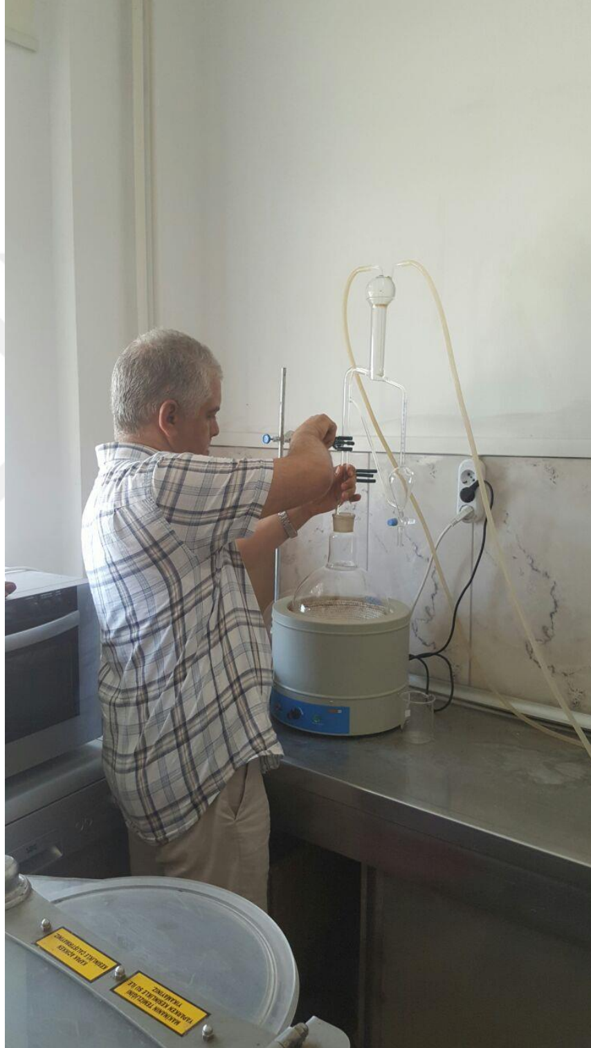
Fotoğraf 3.4. Clevenger cihazında su buharı distilasyonu yöntemiyle uçucu yağ eldesi
