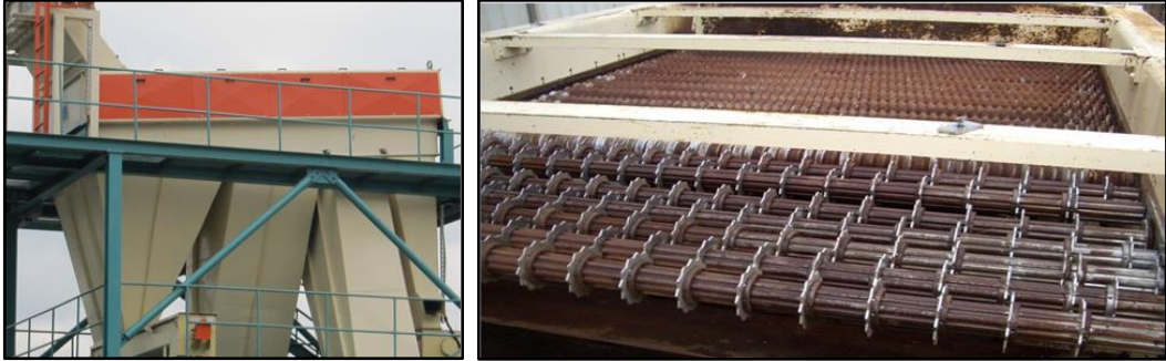
Fotoğraf 2.4. Diskli (Dyna-Screen) elek(a. Diskli elek dış görünüşü,b. Diskli elek iç görünüşü).
