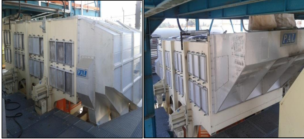
Fotoğraf 2.8. Yonga/talaş tasnif elekleri(a. Elek yan görünümü. b. Elek giriş bölümü).
