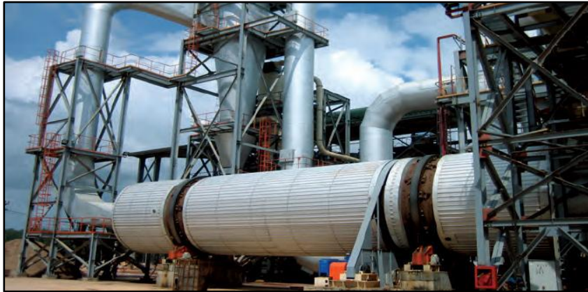
Fotoğraf 1.4. Döner silindirik kurutma makinası genel görünüşü (URL-10, 2015).
