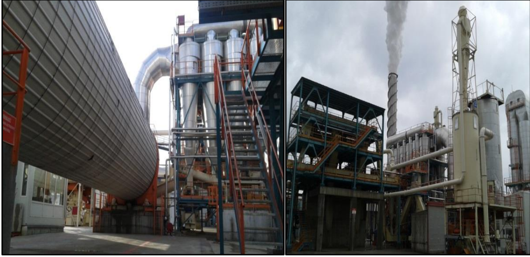
Fotoğraf 2.7. Yonga levha tesisi kurutma ünitesi.( a. Döner silindirli kurutucu, b. Kurutma ünitesi genel görünüşü).
