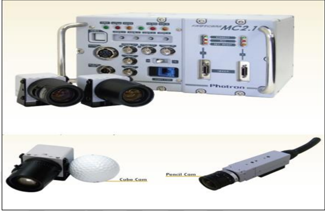
Fotoğraf 3.2. Fotoğraf makinası (Photron Fastcam Mc) ve parçaları
