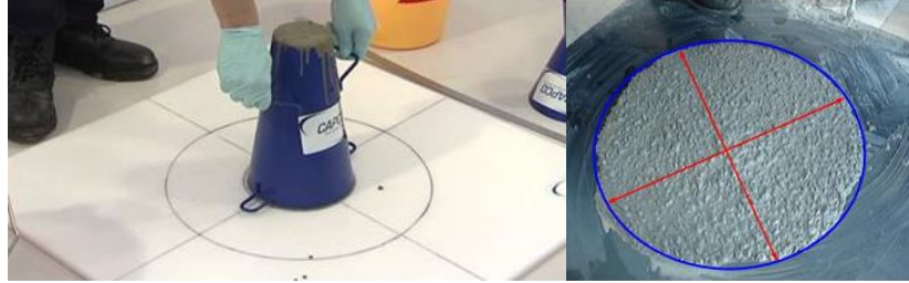
Şekil 2.6.Çökme yayılma testi yapılışı
