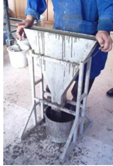
Şekil 2.8. V-Hunisi testi (Upadhyay vd., 2011).
