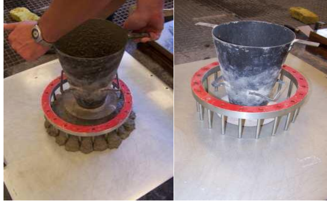
Şekil 2.13. J-halkası testi (Sugárve Takacs, 2013).
