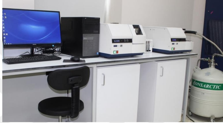
Fotoğraf 3.7. Termogravimetrik analiz (TGA) cihazı
