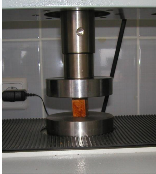
Fotoğraf 3.4. Liflere paralel basınç direnci deneyi
