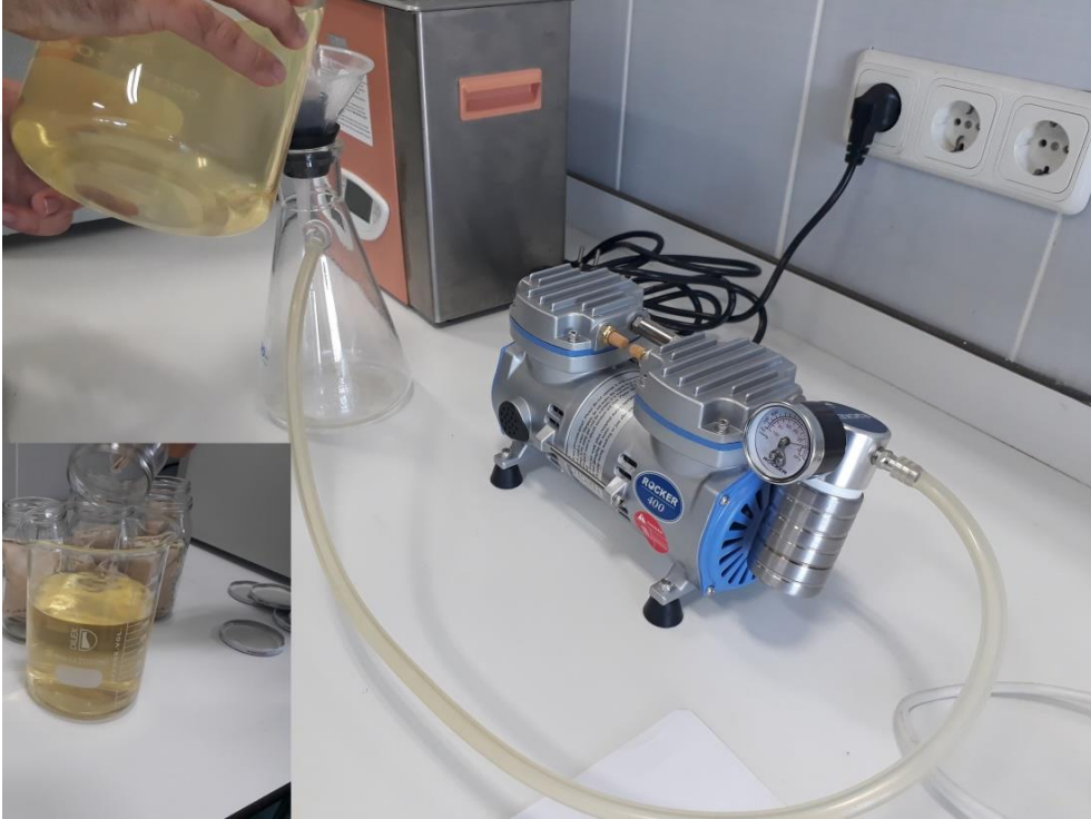
Fotoğraf 3.7. Patrikller vakumlu szme aracı ile ayrıştırılması
