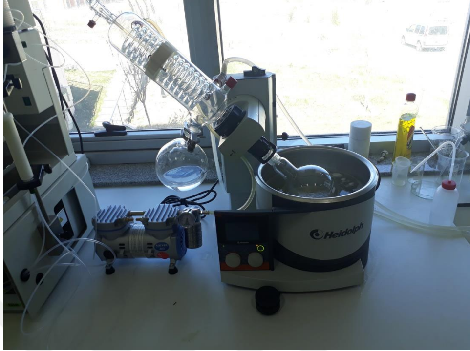
Fotoğraf 3.8. Laboratuvarında evaporatör cihazı ile metanolin uzaklaştırılması
