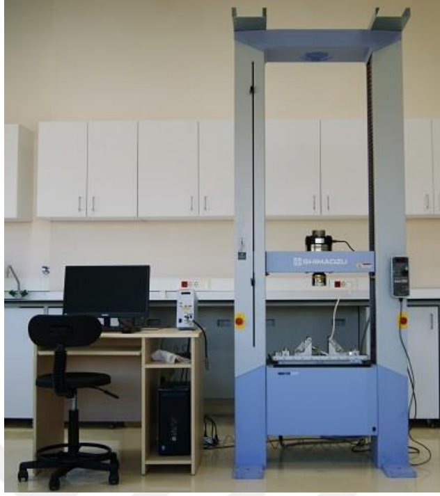
Şekil 4.6. Basma testlerinde kullanılan üniversal test cihazı
