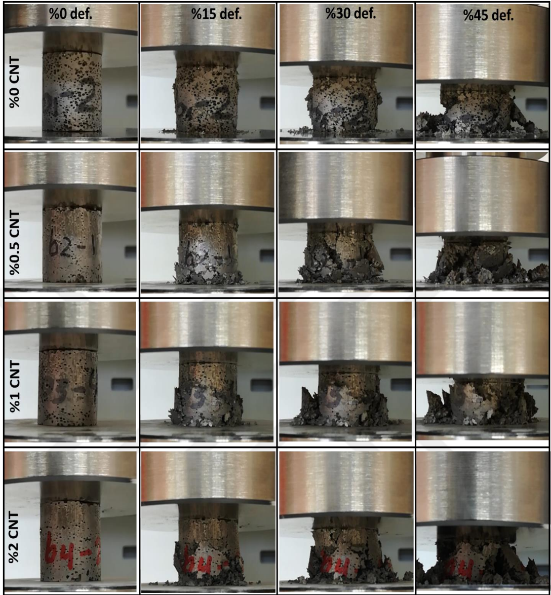
Şekil 5.19. %50 üre ile üretilen köpük numunelerin bastama testi esnasındaki defarmasyon davranışları
