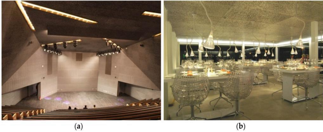
Şekil 3.6. Ses kontrolü için Alusion köpük ile kaplı (a) seyirci salonu, (b) restoran (Cymat) (Das, 2016)
