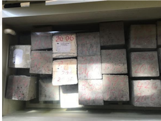
Şekil 3.12. Numunelerin kür edilmesi
