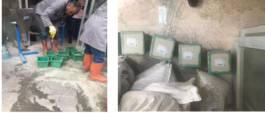
Şekil 3.11. Numunelerin kalıplara yerleştirilmesi
