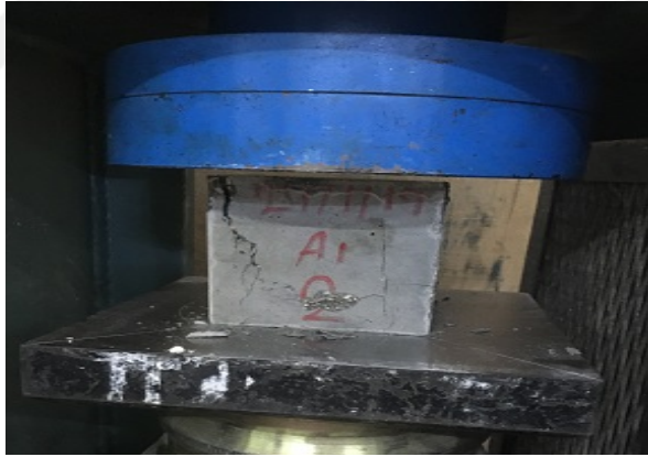
Şekil 3.8. Basınç testi altındaki beton küp
