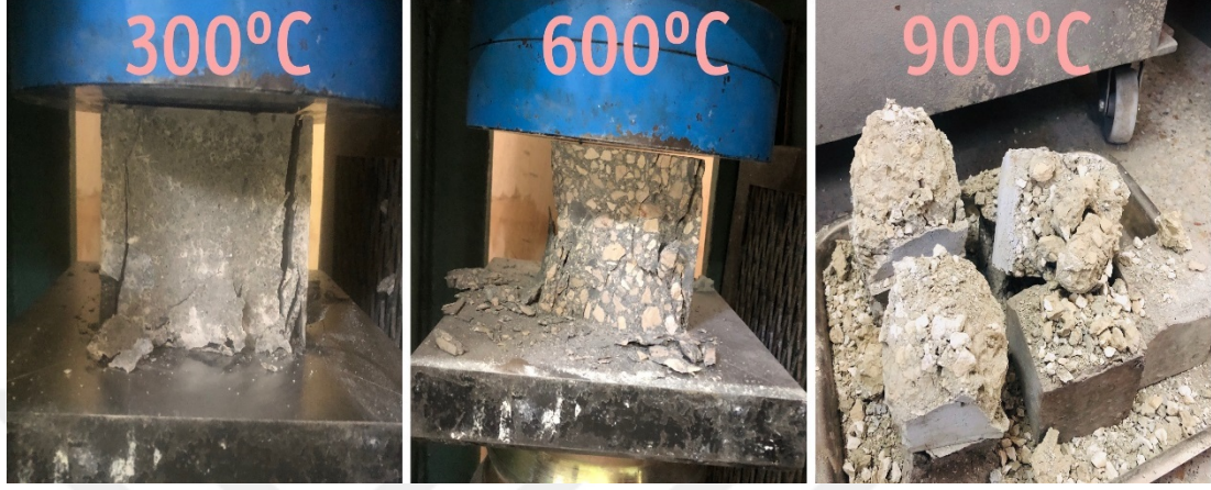
Şekil 3.9. Yangın dayanımı sonrası numune kırımı
