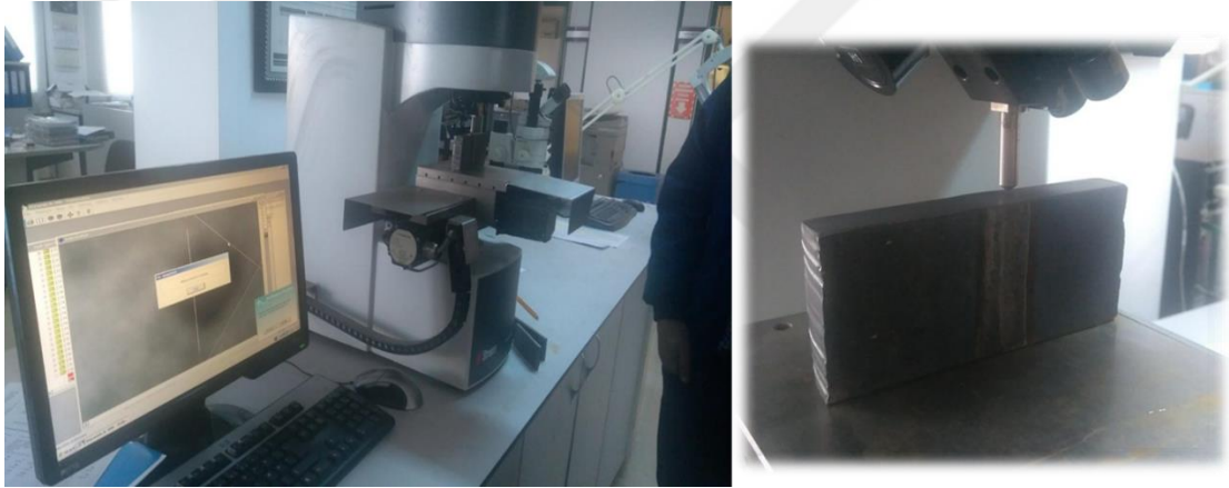
Şekil 3.5. Sertlik ölçüm cihazı için sertlik test cihazı ve test örneklerinin fotoğrafı
