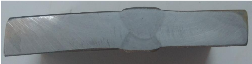
Şekil 3.1. SAW ile birleştirilmiş X70M
